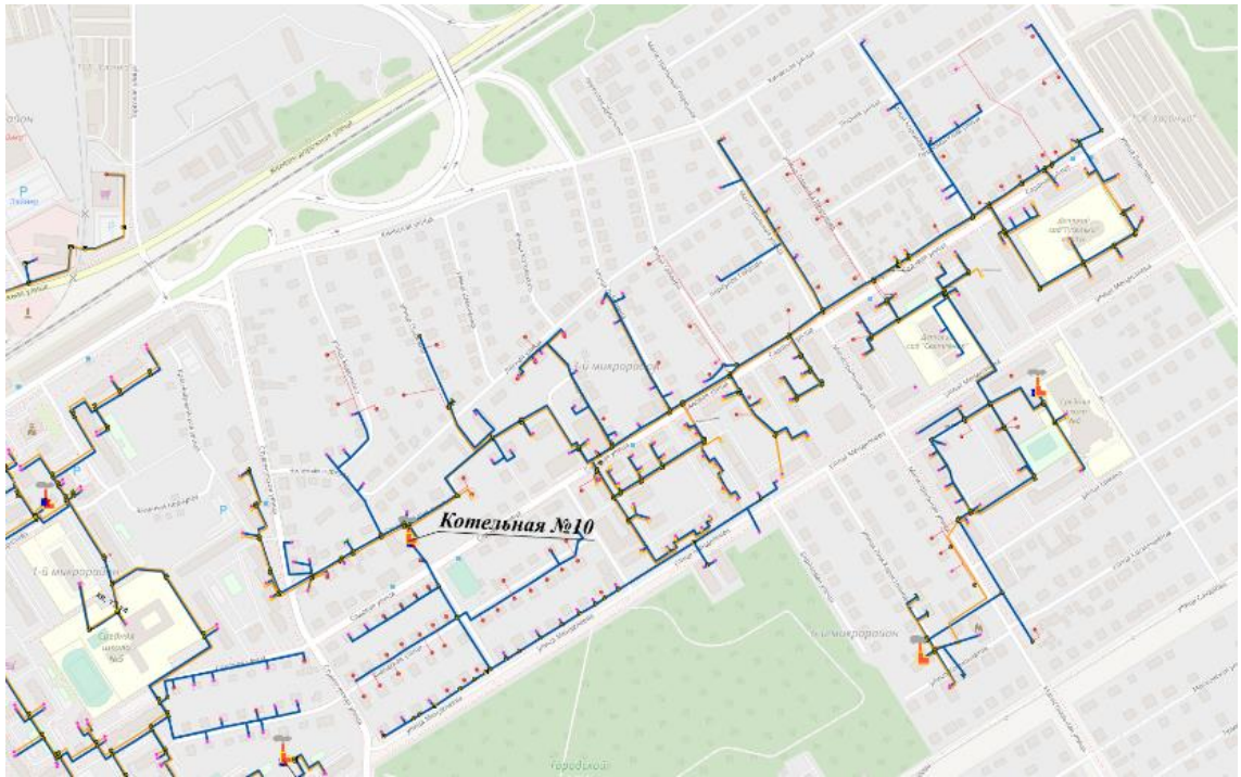
Рисунок 1.5. Схема тепловых сетей в зоне действия котельной №10
