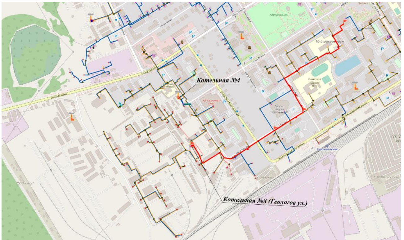
Рисунок 4.15. Путь построения пьезометрического графика ТС от котельной №8
