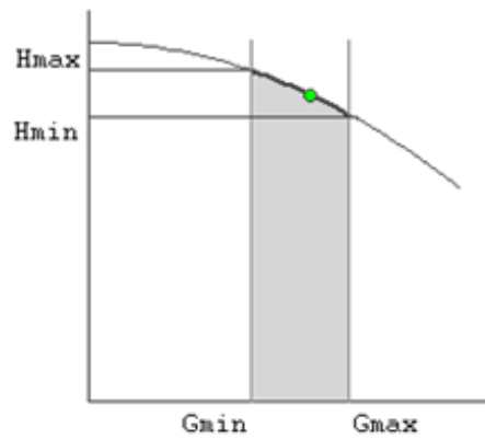
Рисунок 3.17 Напорно-расходная характеристика насоса
