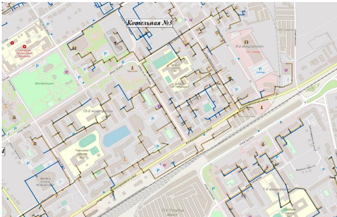
Рисунок 1.3. Схема тепловых сетей в зоне действия котельной №3
