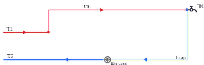
Рисунок 1.18. Потребитель с открытым водоразбором и циркуляционной линией
