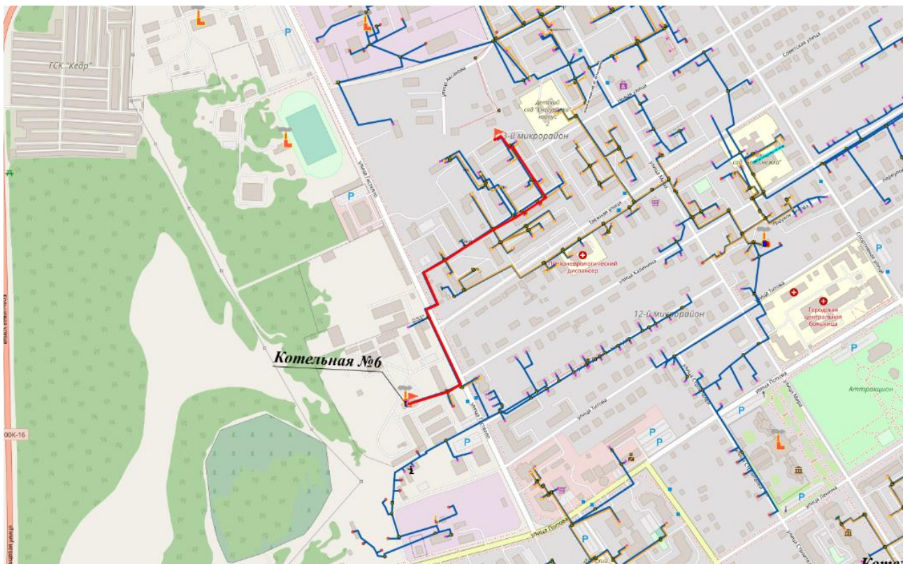
Рисунок 4.8. Путь построения пьезометрического графика ГВС от котельной №6
